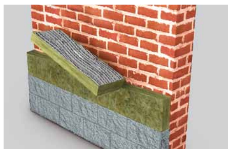
Lepenie minerálnovláknitých lamiel. Celoplošné lepenie pomocou hrebeňa (NOBASIL FKL)
