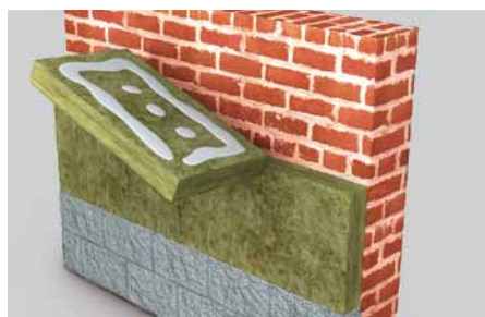
Lepenie minerálnovláknitých dosiek s uzavretou okrajovou húsenicou a bodovým lepením (NOBASIL FKD S, FKD)
